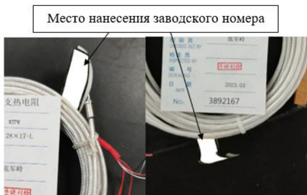
Рисунок 4 – Место нанесения заводского номера на самоклеящуюся информационную табличку (шильдик) для ТС модификаций WZPM, WZCM и WZPD, WZCD
