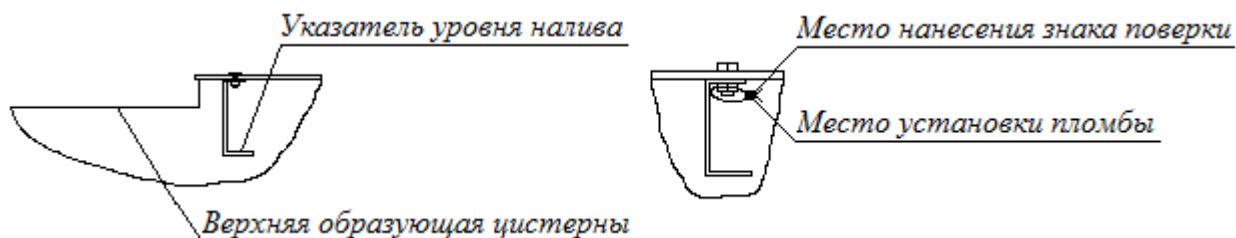
Рисунок 4 – Схема пломбировки от несанкционированного изменения положения указателя уровня налива, обозначение места нанесения знака поверки
