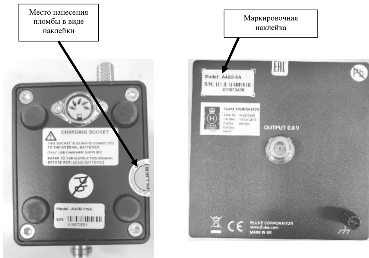
Рисунок 3 – Схема пломбировки от несанкционированного доступа, место нанесения маркировочной наклейки
