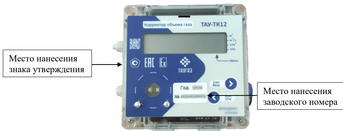
Рисунок 2 – Место нанесения заводского номера, знака утверждения типа
