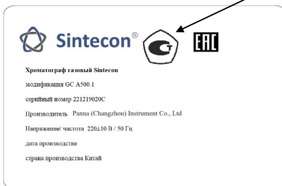
Рисунок 5 – Общий вид маркировочной таблички (стрелкой обозначено место нанесения знака утверждения типа)
