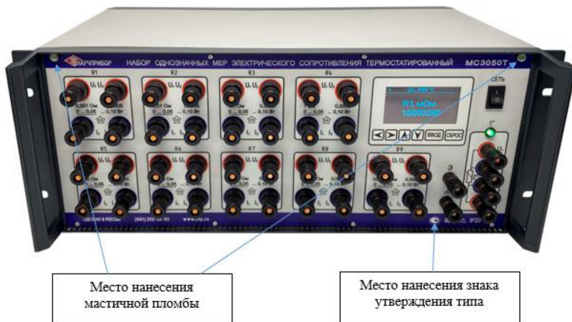
Рисунок 1 - Общий вид НОМЭСТ модификаций MC3050T-1, MC3050T-2 с указанием мест пломбировки от несанкционированного доступа, места нанесения знака утверждения типа (на примере модификации MC3050T-2)
