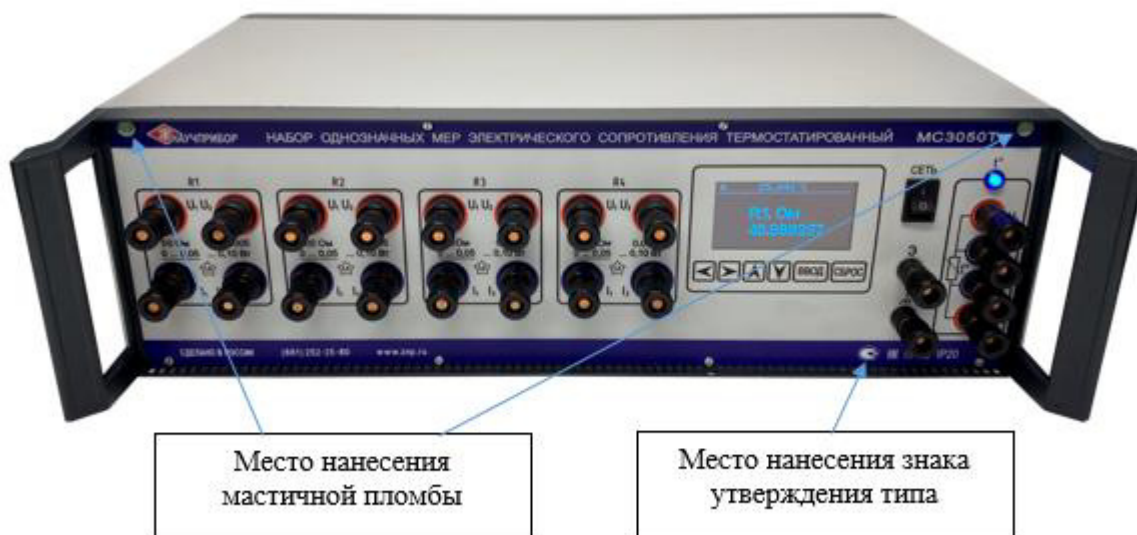
Рисунок 2 - Общий вид НОМЭСТ модификаций MC3050T-3, MC3050T-4 с указанием мест пломбировки от несанкционированного доступа, места нанесения знака утверждения типа (на примере модификации MC3050T-3)
