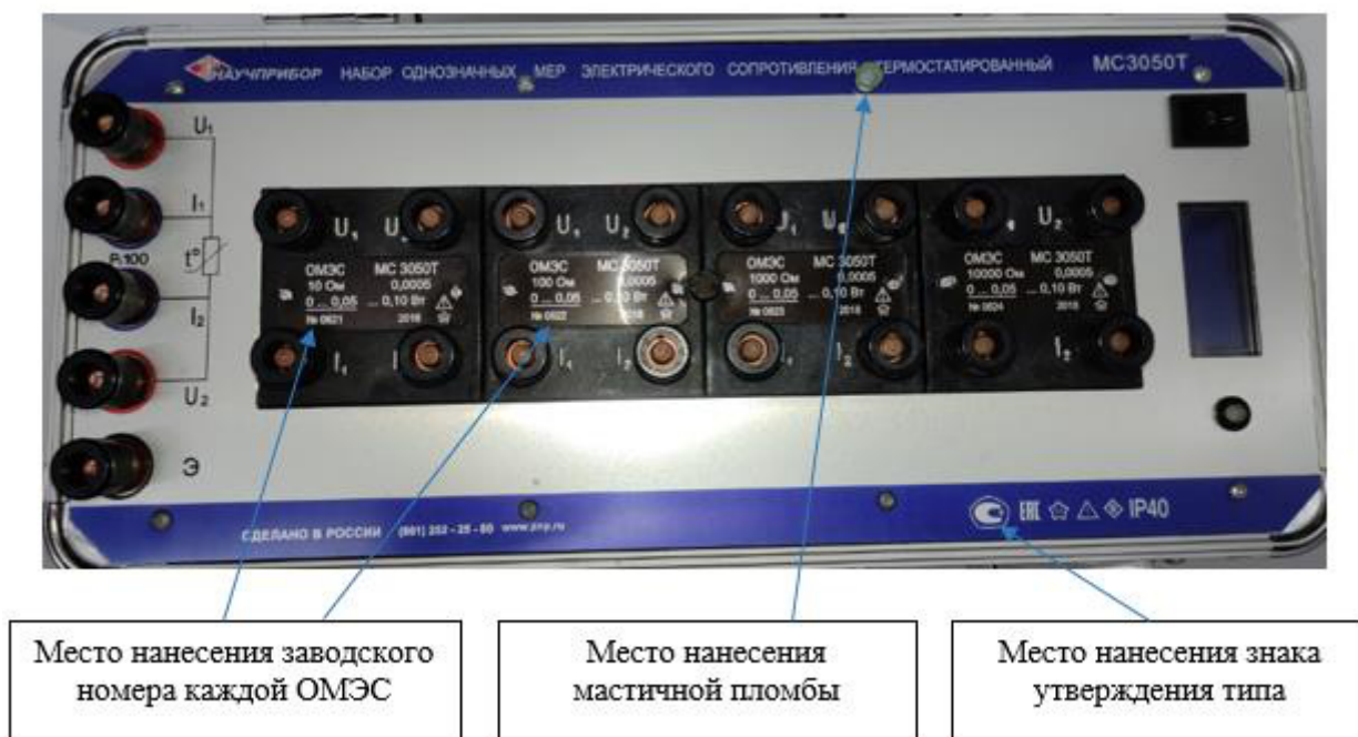
Рисунок 7 - Общий вид верхней (лицевой) панели НОМЭСТ модификации MC3050T-6, с указанием мест пломбировки от несанкционированного доступа, мест нанесения заводского номера ОМЭС и знака утверждения типа
