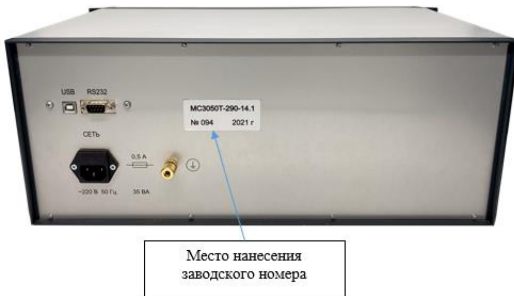
Рисунок 4 - Общий вид задней панели НОМЭСТ модификаций MC3050T-1, MC3050T-2, MC3050T-3, MC3050T-4, MC3050T-5 с указанием места нанесения заводского номера
