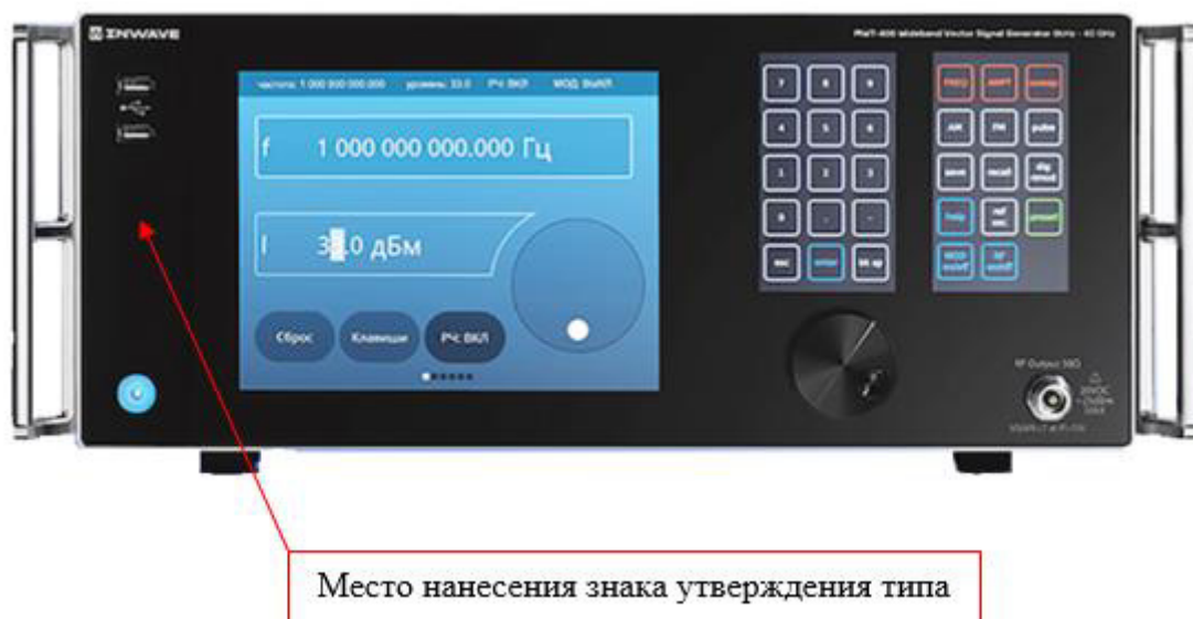
Рисунок 1 – Общий вид генераторов сигналов векторных MWT модификаций MWT-200, MWT-400 с опцией встроенного ПК; место для нанесения знака утверждения типа
