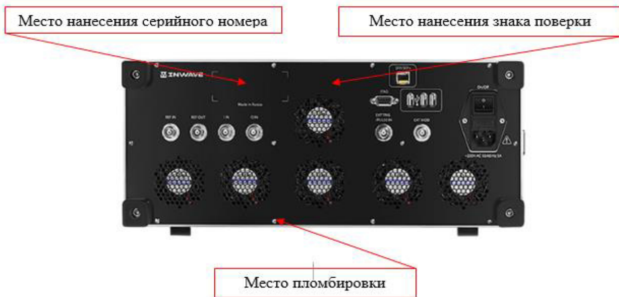
Рисунок 5 – Схема пломбировки от несанкционированного доступа; места нанесения серийного номера и знака поверки, для генераторов сигналов векторных MWT модификаций MWT-200, MWT-400
