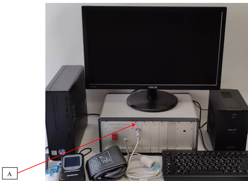
Рисунок 1 – Общий вид комплексов и схема пломбирования от несанкционированного доступа (А)
