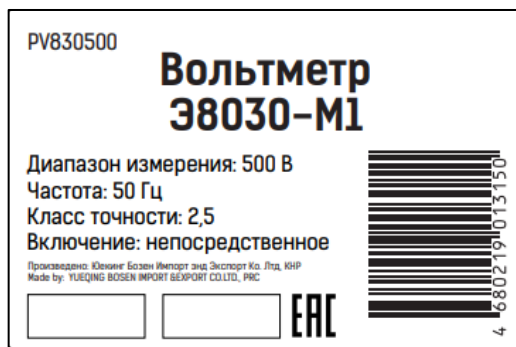
Рисунок 3 – Пример маркировки вольтметров
