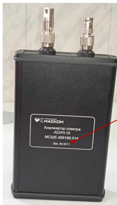
Рисунок 2 – Общий вид анализаторов спектра АСНЧ-12 с указанием мест пломбировки, нанесения заводского номера
