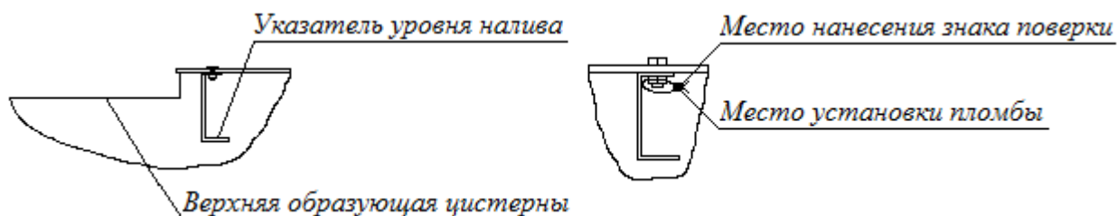
Рисунок 2 – Схема пломбировки от несанкционированного изменения положения указателя уровня налива, обозначение места нанесения знака поверки
