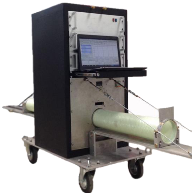
Рисунок 1 – Общий вид установок мобильных для ЯМР-анализа полноразмерного керна ЯМР-Керн
