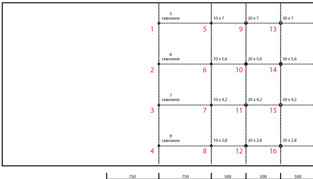
Рисунок 2 – Схема расположения дефектов в секции №1 меры
