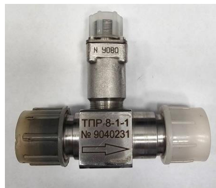
Рисунок 12 – Преобразователь расхода турбинный ТПР
