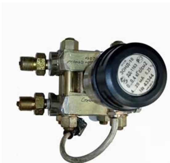
Рисунок 5 – Преобразователь измерительный давления ЗОНД-10
