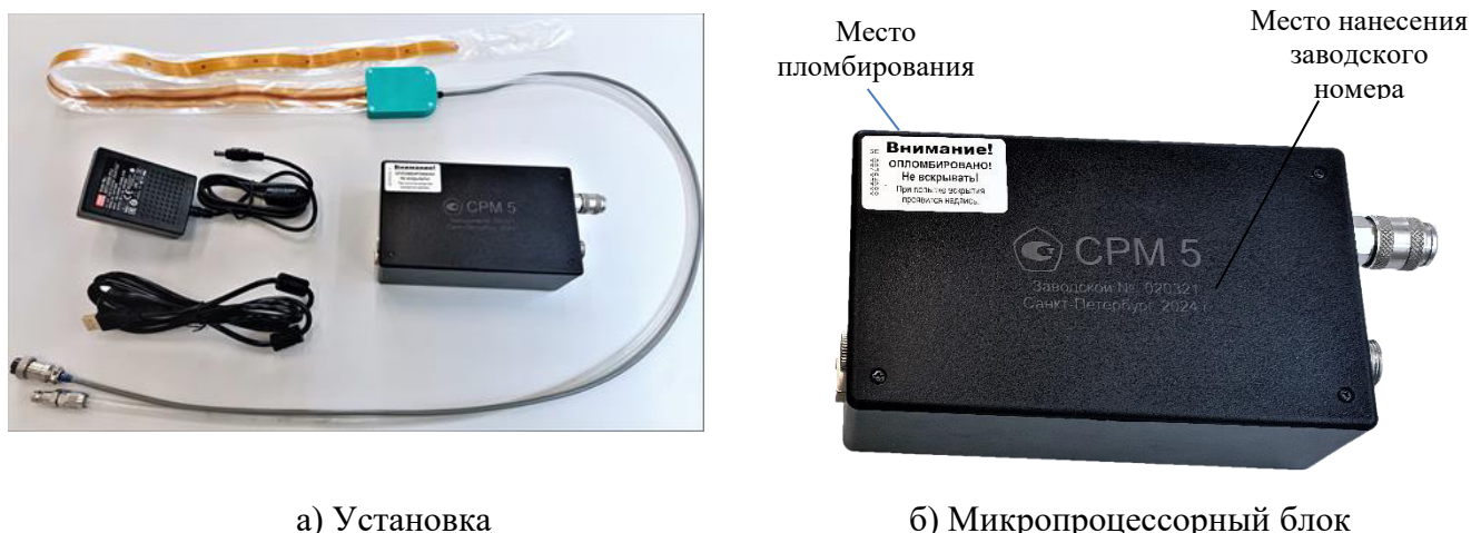
Рисунок 1 – Общий вид установки для тестирования компрессионных медицинских изделий CPM 5
