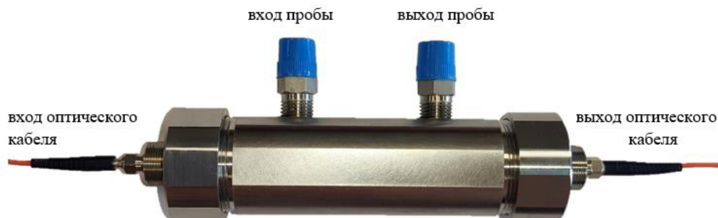
Рисунок 4 – Общий вид измерительной ячейки анализатора
