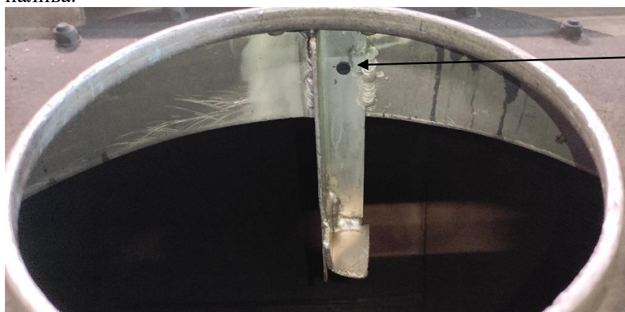
Рисунок 3 – Схема пломбировки от несанкционированного изменения положения указателя уровня налива, обозначение места нанесения знака поверки
