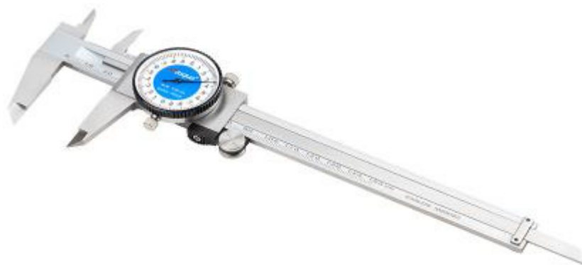
Рисунок 4 – Общий вид штангенциркулей исполнений с отсчетом по круговой шкале двусторонних с глубиномером (лист 1 из 3)
