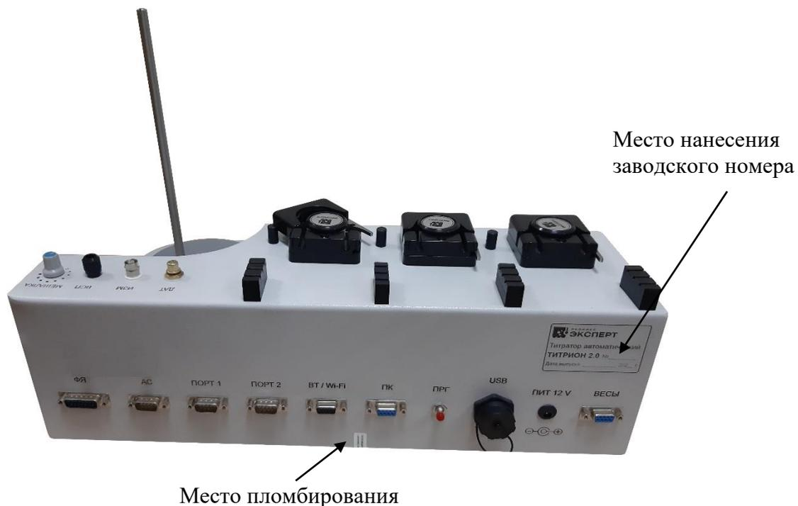
Рисунок 2 – Место пломбирования СИ и место нанесения заводского номера
