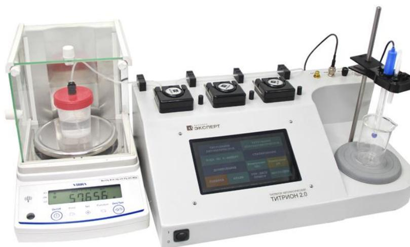
Рисунок 1 – Общий вид титратора автоматического ТИТРИОН 2.0
