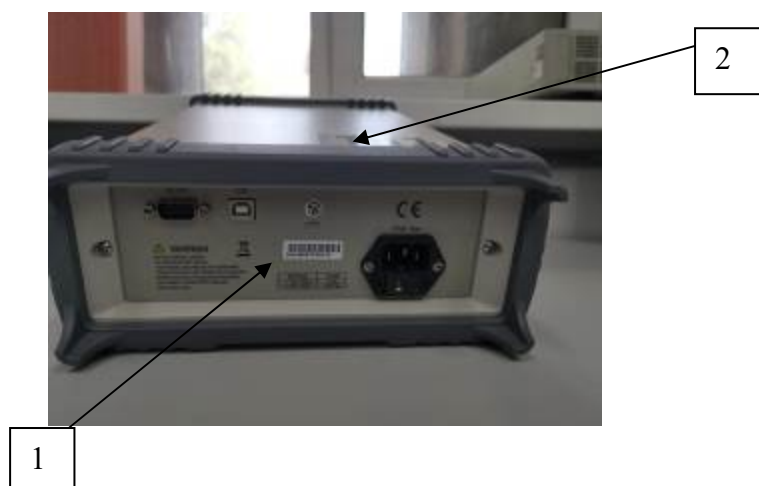
Рисунок 3 – место нанесения заводского номера (1); место нанесения знака поверки, знака ТР ТС (2) на примере задней панели модификации MB2102
