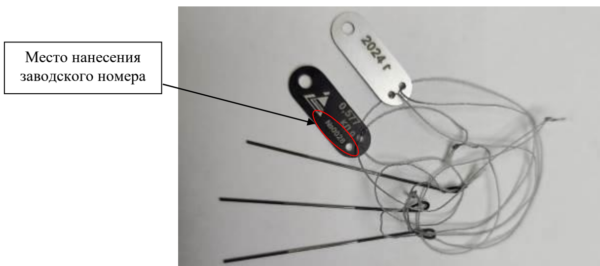
Рисунок 2 – Общий вид проволоочек ступенчатых типа II с указанием места нанесения заводского номера
