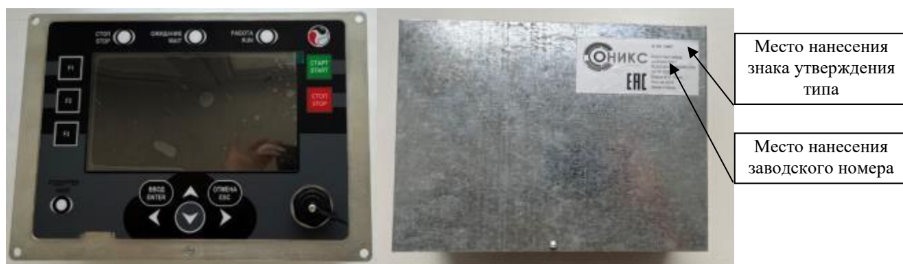
Рисунок 1 – Общий вид контроллеров и места нанесения заводского номера и знака утверждения типа на контроллеры
