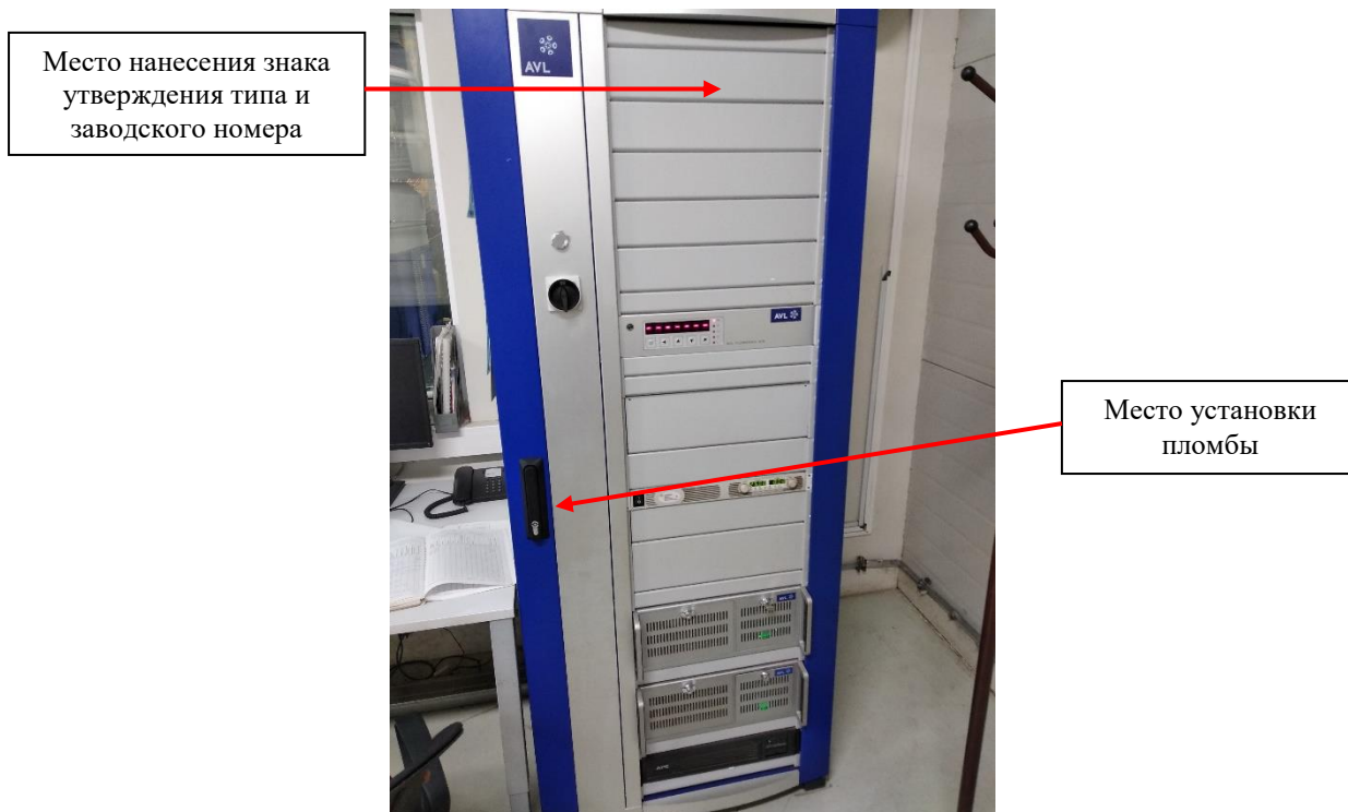
Рисунок 1 – Модуль сбора измерений, управления, автоматизации и регулирования. Общий вид
