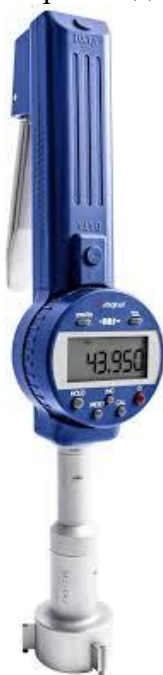
Рисунок 7 – Общий вид нутромеров модели 4600 с указанием места нанесения заводского номера
