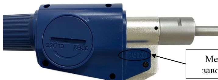
Рисунок 6 – Общий вид нутромеров модели 4511 с указанием места нанесения заводского номера
