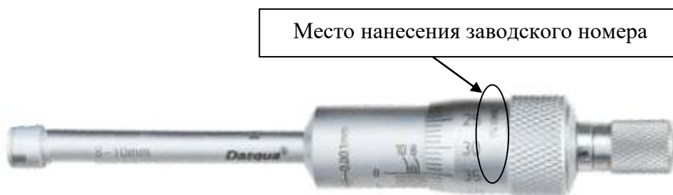
Рисунок 1 – Общий вид нутромеров модели 4411 с указанием места нанесения заводского номера
