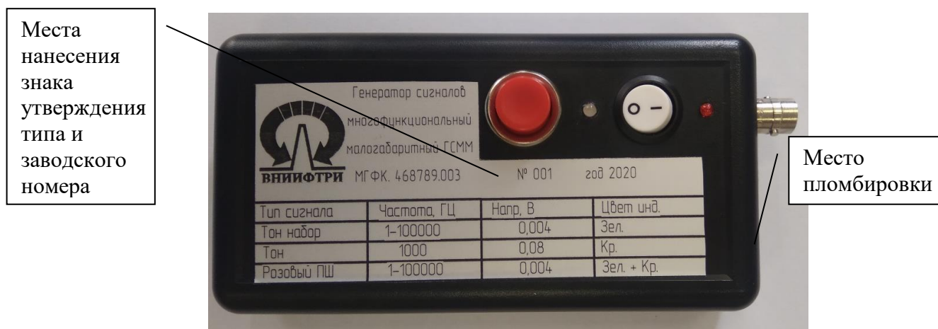
Рисунок 1 - Общий вид генераторов, место нанесения знака утверждения типа, заводского номера и место пломбировки от несанкционированного доступа
