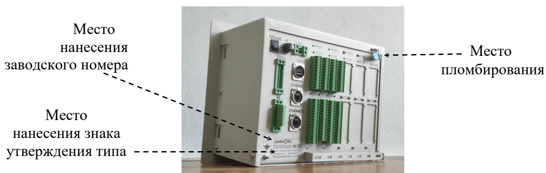
Рисунок 3 – Пломбирование вычислителей и расположение мест нанесения заводского номера и знака утверждения типа
