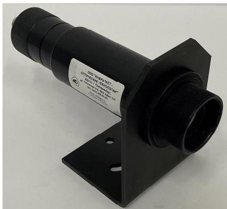
Рисунок 1 – Общий вид пирометров Термоскоп модификации Термоскоп-200
