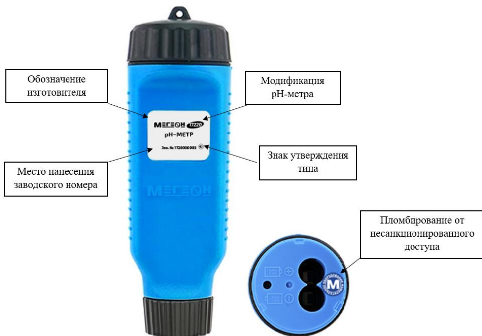
Рисунок 4 – Идентификационная табличка и пломбирование pH-метров
