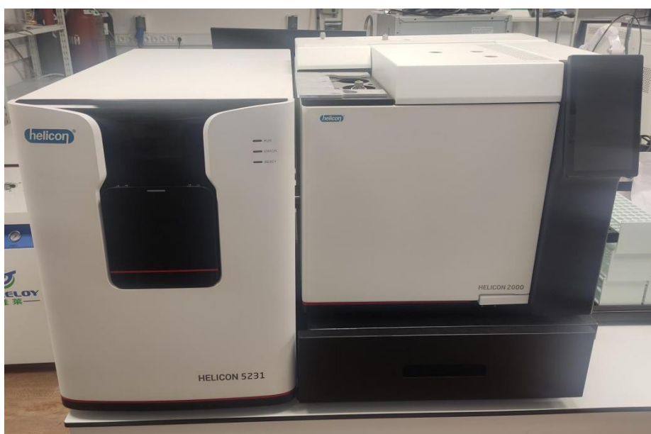
Рисунок 2 – Общий вид хроматографов газowych HELICON 2000 с масс-спектрометрическим детектором HELICON 5231
