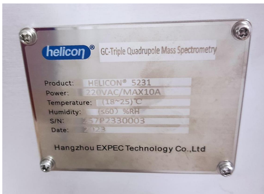
Рисунок 4 – Общий вид металлической пластинки (шильдика) масс-спектрометрических детекторов HELICON 5231
