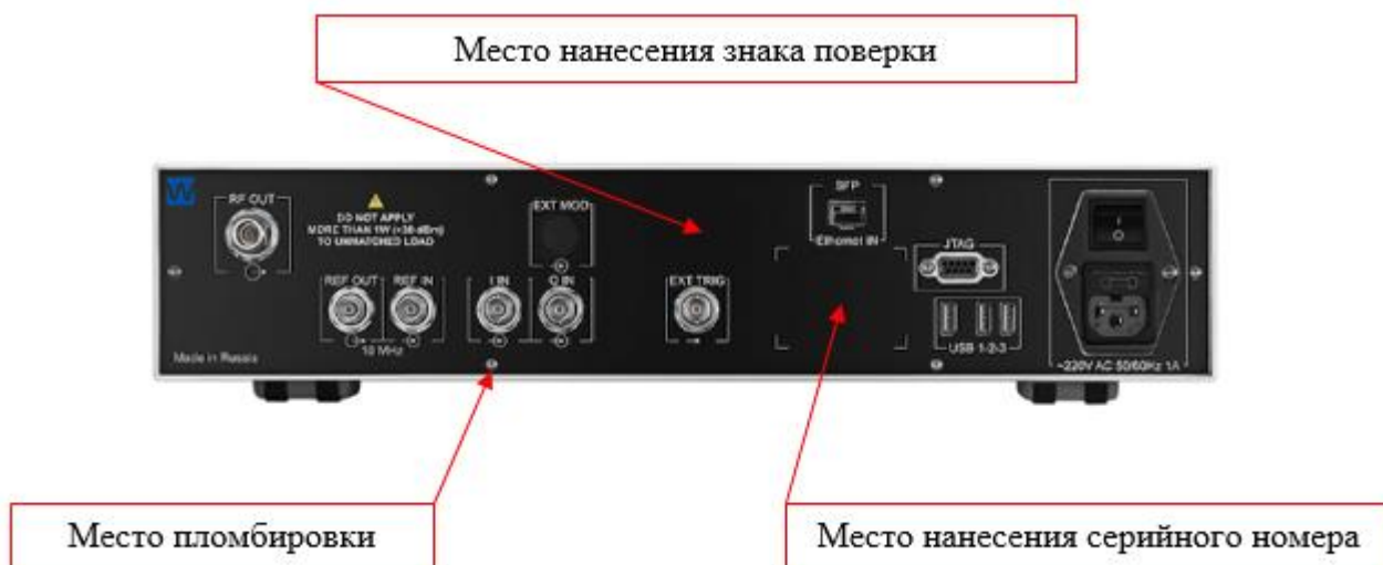
Рисунок 6 – Схема пломбировки от несанкционированного доступа; места нанесения серийного номера и знака поверки для генераторов сигналов MWG модификаций MWG-60U, MWG-100U, MWG-160U, MWG-200U
