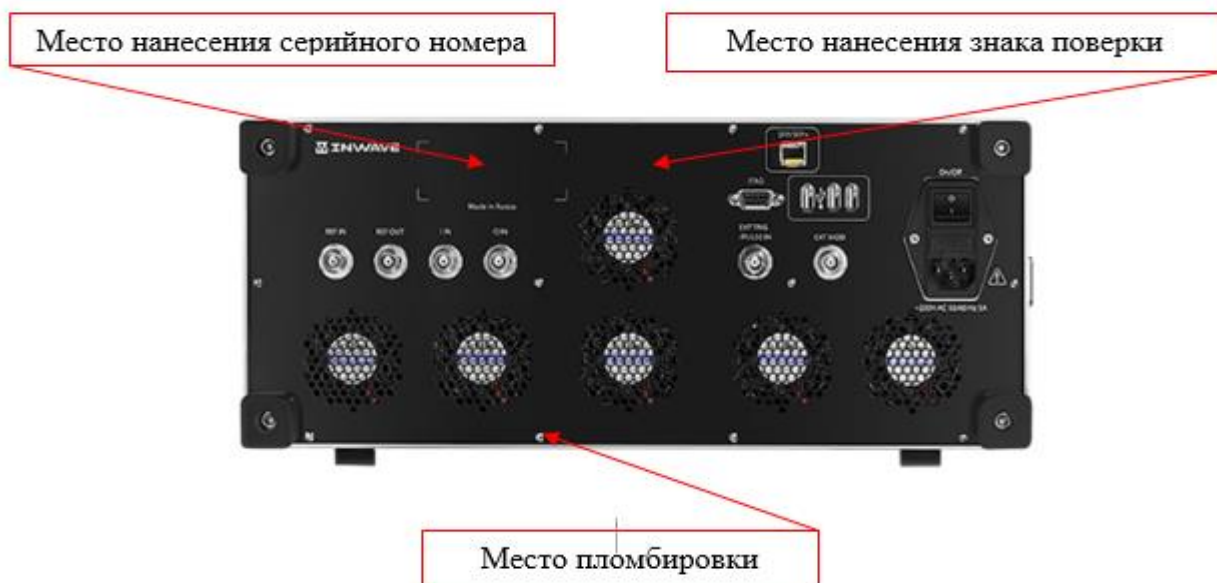
Рисунок 5 – Схема пломбировки от несанкционированного доступа; места нанесения серийного номера и знака поверки для генераторов сигналов MWG модификаций MWG-200, MWG-400
