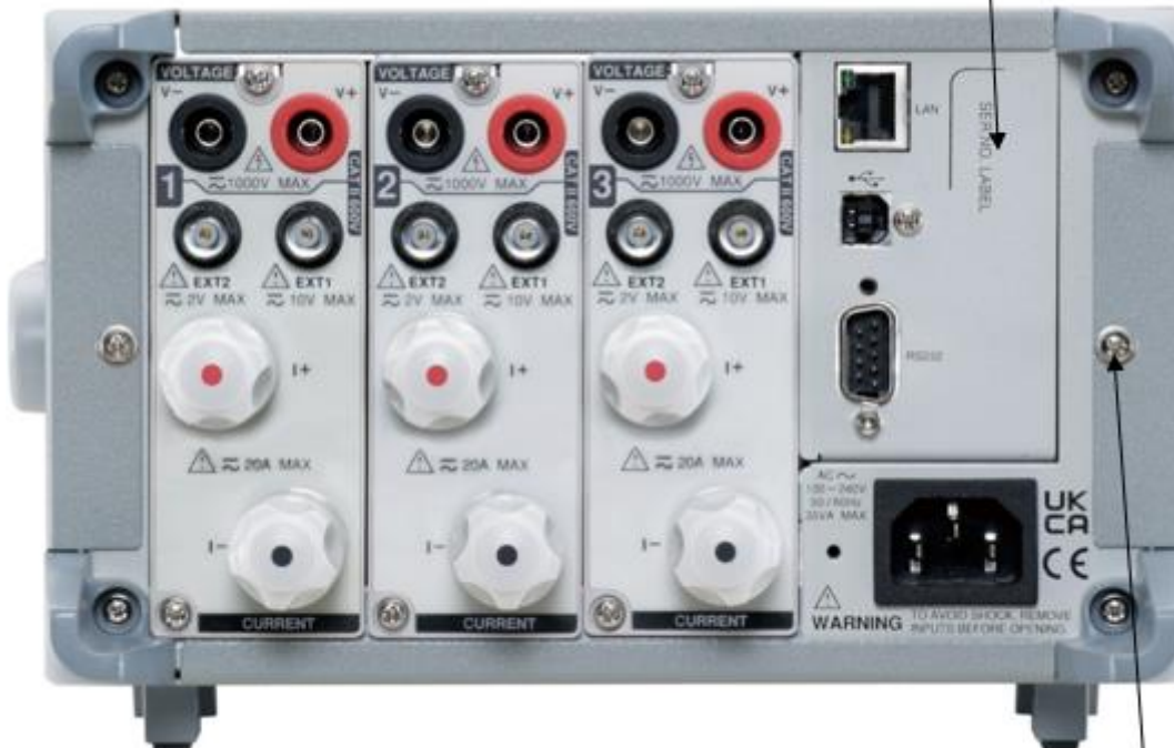
Рисунок 5 - Место нанесения заводского номера измерителей электрической мощности GPM-78330 и схема пломбирования от несанкционированного доступа
