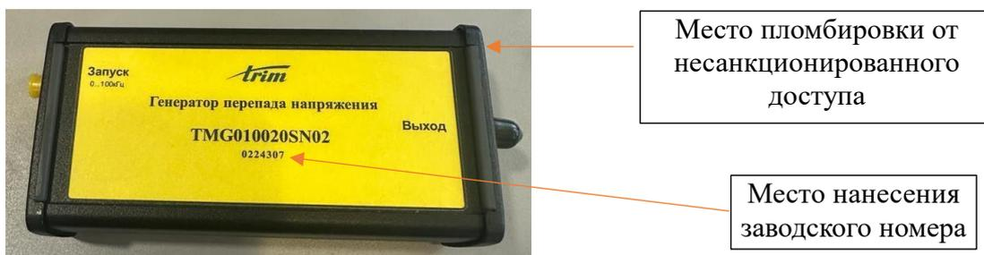
Рисунок 3 – Общий вид генератора перепада напряжения TMG010020SN02
