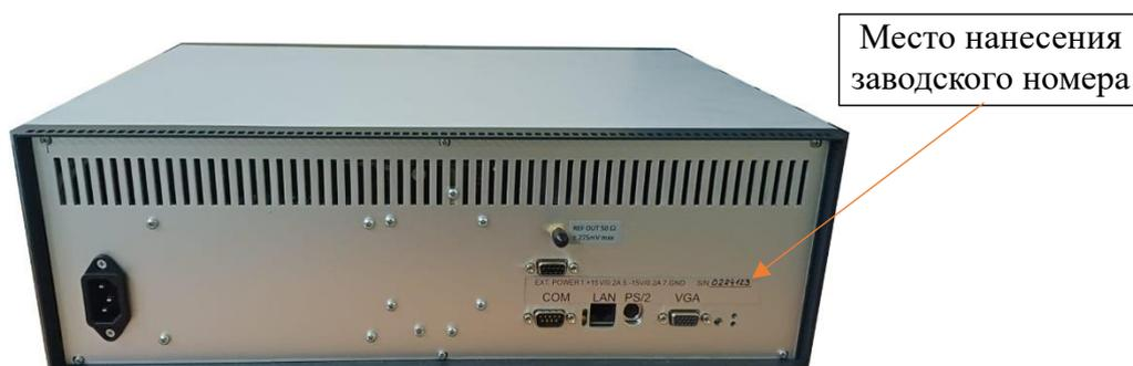
Рисунок 2 – Вид задней панели осциллографа TMR8250 с указанием места нанесения
