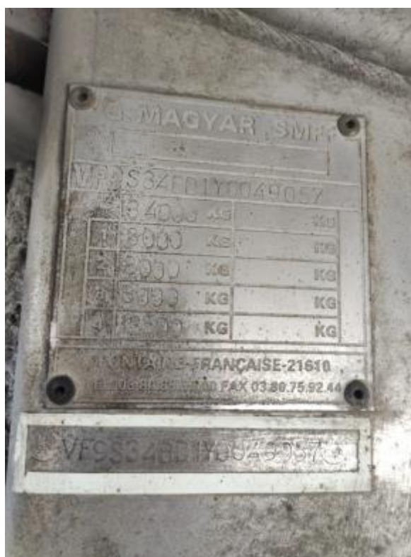
Рисунок 2 – Общий вид маркировочной таблички MAGYAR S34BD1A
