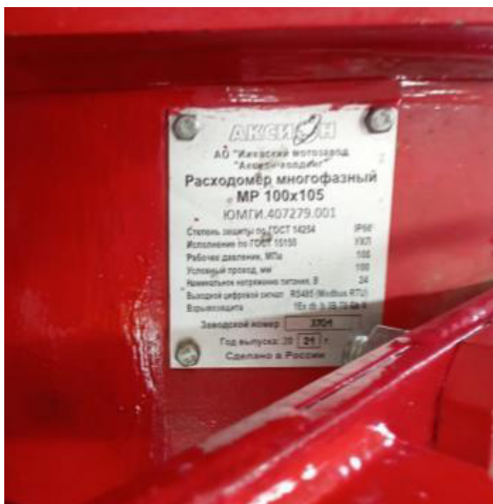
Рисунок 2 – Расходомеры многофазные MP 100x105. Место нанесения заводских номеров
