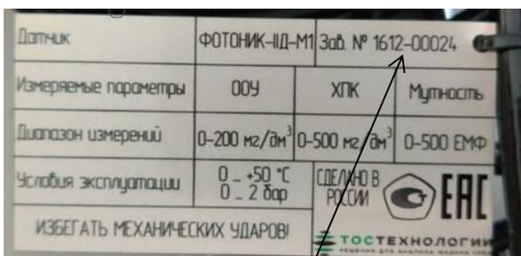
в) общий вид маркировочной таблички датчика ФОТОНИК-ИД-М1 с заводским номером
