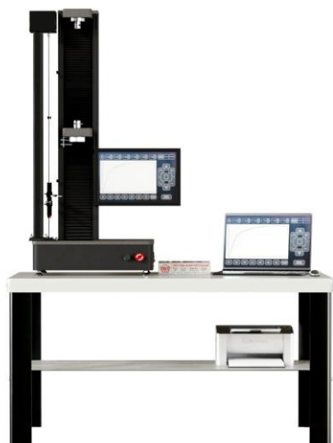
а) Машины уменьшенной высоты, с примером установки датчика продольной деформации
