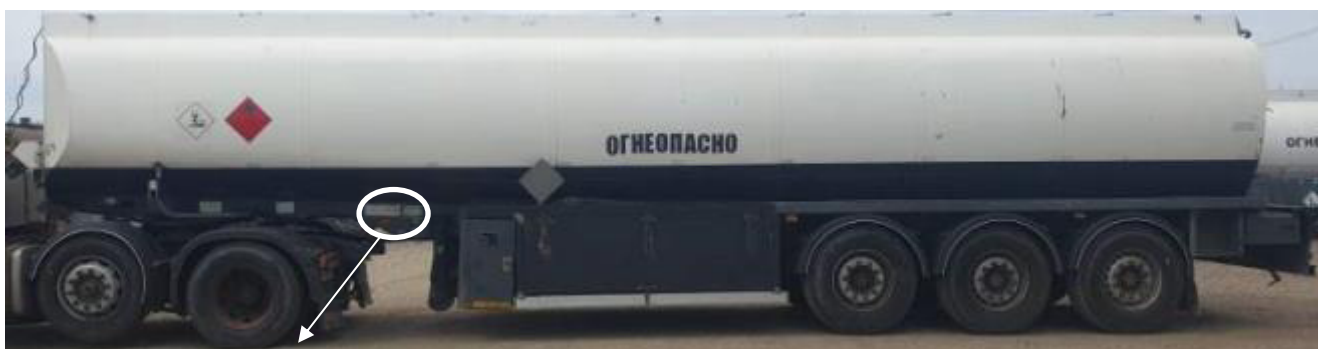
Рисунок 2 – Общий вид полуприцепа-цистерны THOMPSON CARMICHAEL PT44/3 зав. № 2159 и место нанесения заводского номера
