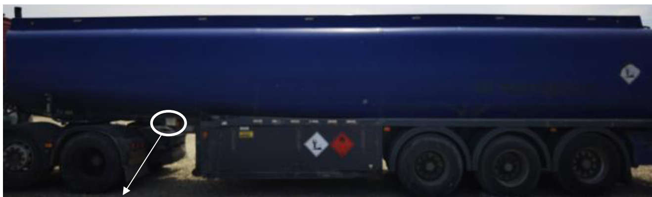
Рисунок 1 – Общий вид полуприцепа-цистерны THOMPSON CARMICHAEL PT44/3 зав. № SA9PT443001056602 и место нанесения заводского номера
