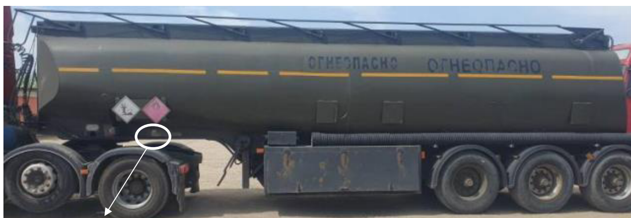
Рисунок 4 – Общий вид полуприцепа-цистерны THOMPSON CARMICHAEL PT44/3 зав. № SA9PT443001056605 и место нанесения заводского номера
