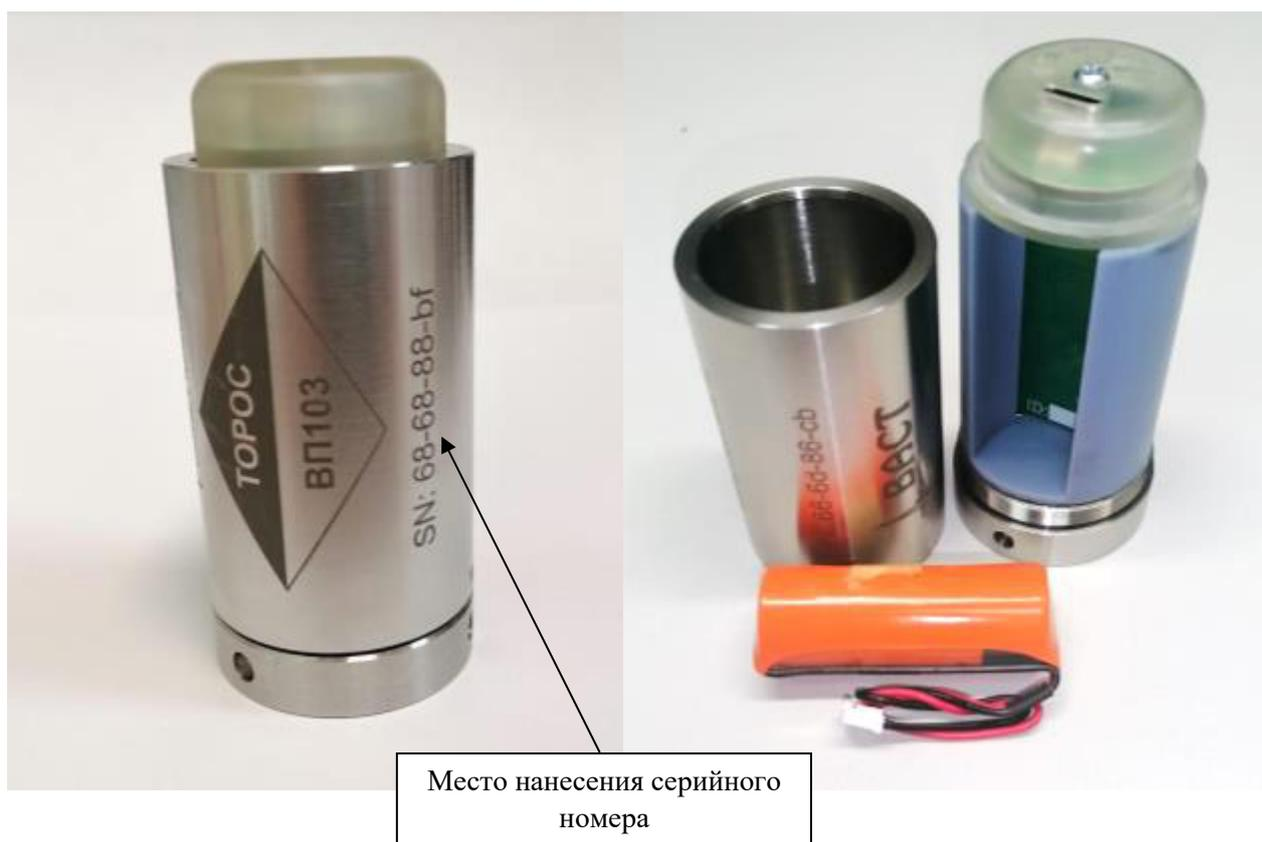
Рисунок 1 – Общий вид вибропреобразователей ТОРОС ВП103
