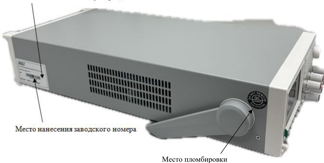
Рисунок 2 - Место нанесения серийного номера, знака утверждения типа и место пломбирования от несанкционированного доступа для источников питания постоянного тока линейных N3410
