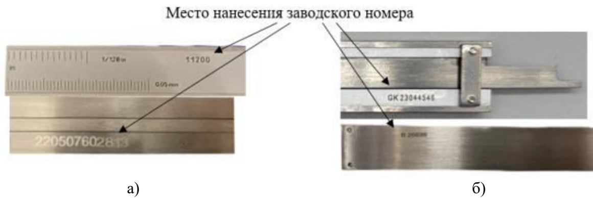
Рисунок 10 – Место нанесения заводского номера на штангенциркули: а) в цифровом формате; б) в буквенно-цифровом формате.
