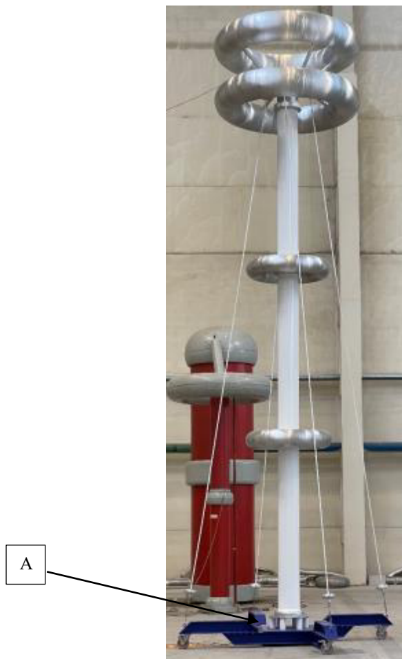
Рисунок 1 – Общий вид делителя напряжения емкостного OWF-1000kV/700pF и обозначение места пломбирования от несанкционированного доступа
