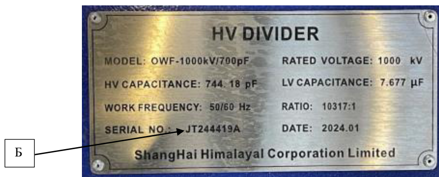
Рисунок 2 – Обозначение места нанесения заводского номера на делитель напряжения емкостной OWF-1000kV/700pF
