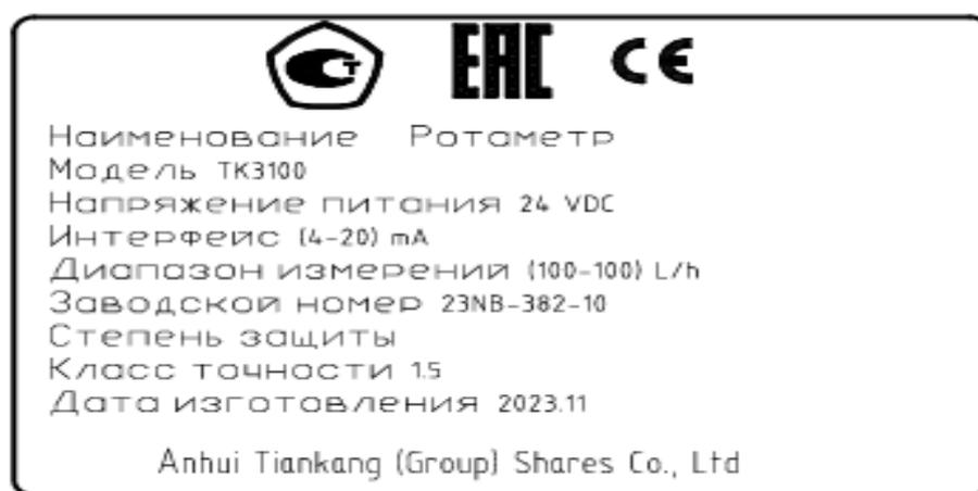
Рисунок 2 – Пример маркировочной таблички
