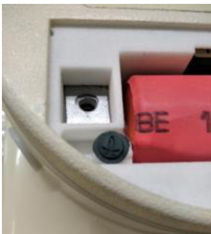
Рисунок 5 – Место пломбирования батарейного отсека измерительного модуля
