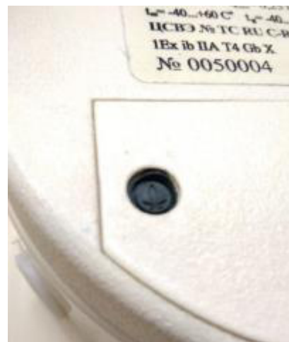
Рисунок 6 – Место пломбирования батарейного отсека коммуникационного модуля
