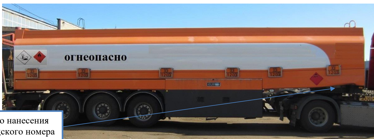
Рисунок 3 – Общий вид полуприцепа-цистерны EUROTANK зав. № YF912V24S85049687 с указанием места нанесения заводского номера
