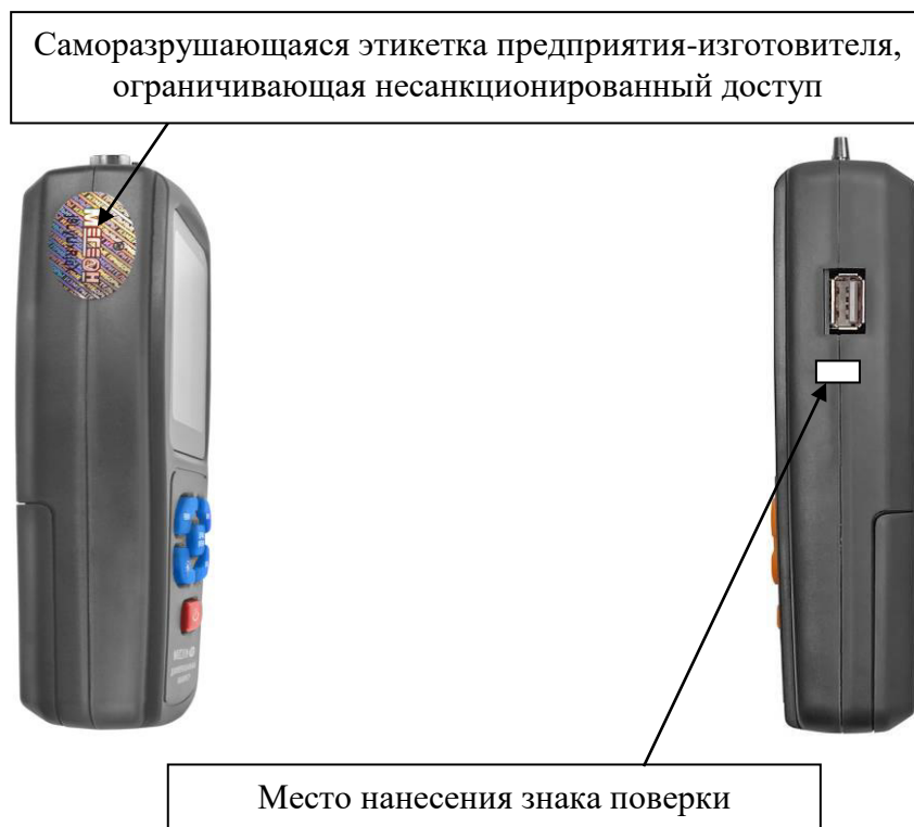
Р и с у н о к 2 – Схема пломбировки от несанкционированного доступа, обозначение места нанесения знака
