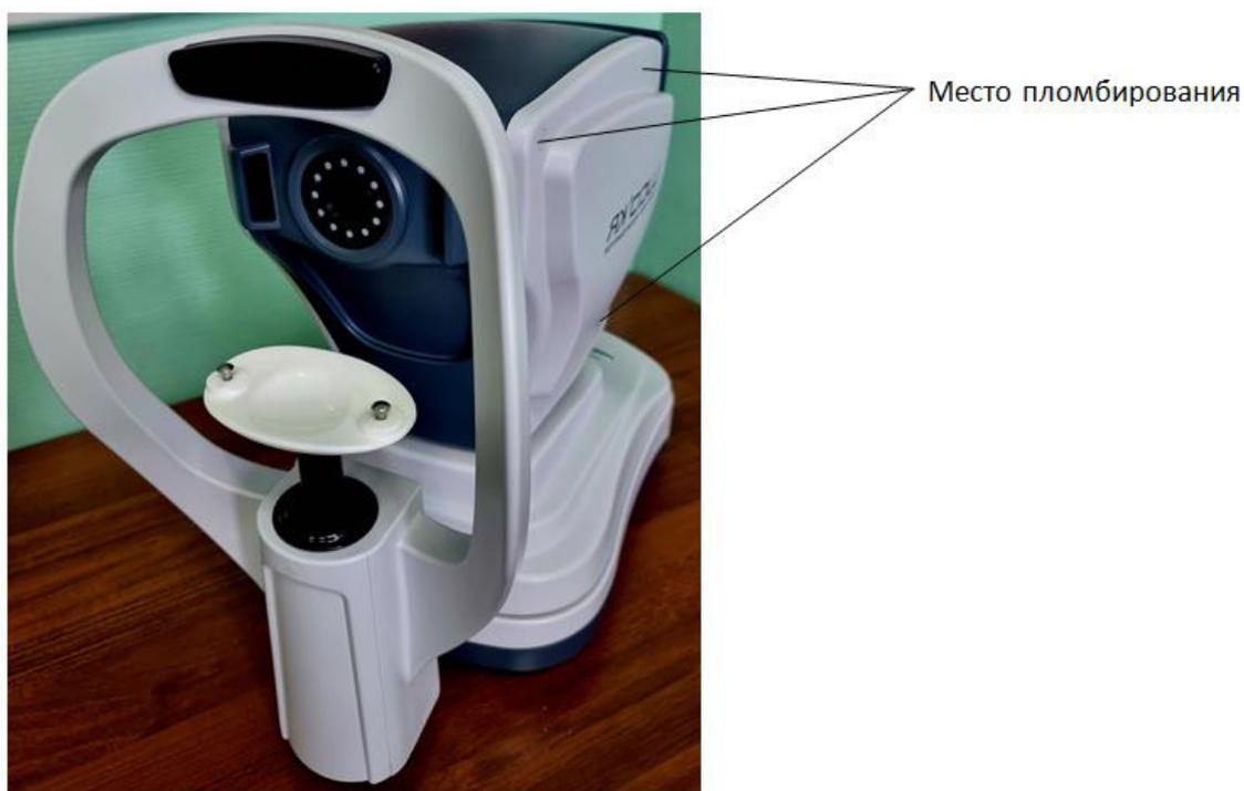
Рисунок 2 – Общий вид и схема пломбирования авторефрактометров от несанкционированного доступа
