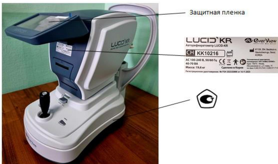
Рисунок 1 – Общий вид и схема маркировки авторефрактометров
