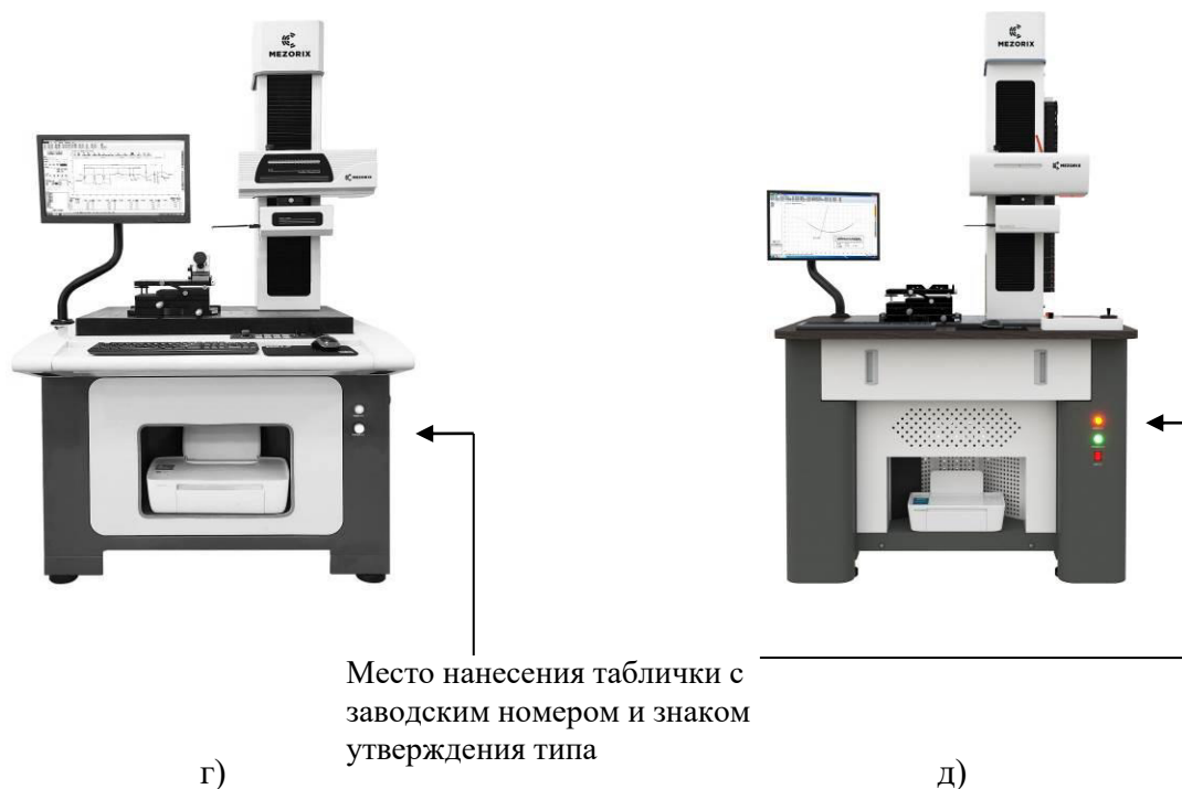
Рисунок 3 – Общий вид приборов для измерений параметров контура и шероховатости поверхности MEZORIX CONTURIX модификации: а) MEZORIX CONTURIX SPR1, б) MEZORIX CONTURIX SPR2, в) MEZORIX CONTURIX SPR3, г) MEZORIX CONTURIX FX8, д) MEZORIX CONTURIX FX10
