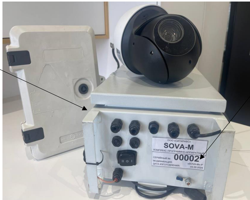
Рисунок 2 – Общий вид комплексов модификации «SOVA-M»-P с обозначением места нанесения знака утверждения типа, серийного номера и места пломбировки от несанкционированного доступа
