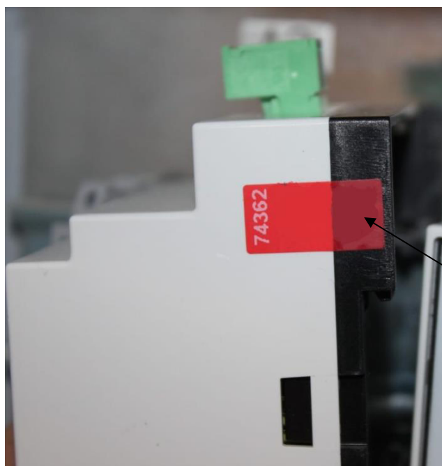
Рисунок 4 – Схема пломбировки от несанкционированного доступа на преобразователе дифференциального давления
