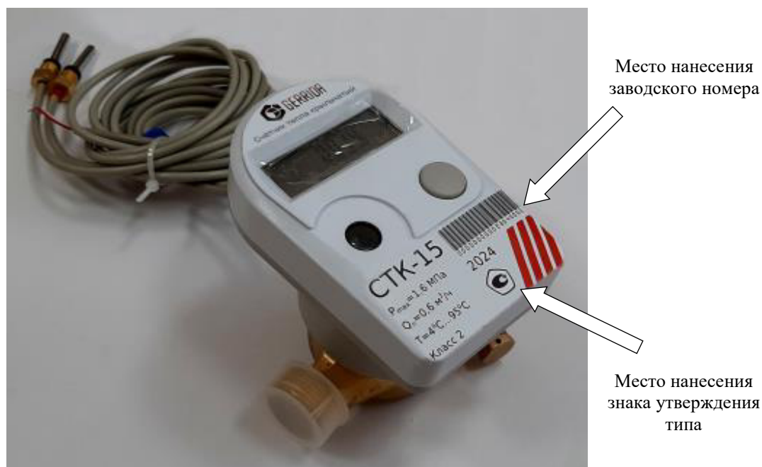
Рисунок 2 – Обозначение мест нанесения знака утверждения типа и заводского номера
